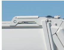
**4** Vérins de levage sur le toit de la trémie.
