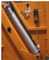
**8** Vérins de compaction à l'extérieur de la trémie.
