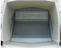
1 Uitdruckschot perfect aangepast aan de opbouw.
