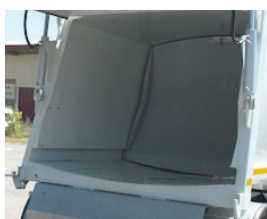
2 Kielvormige vloer met zijdelings geleiding voor het uitdrukschot.
