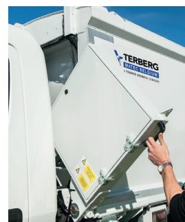
6 Centraal elektrisch paneel, gemonteerd in een gemakkelijk toegankelijke en waterdichte kast.
