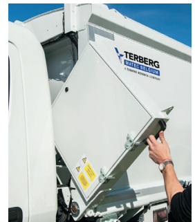
6 Panneau électrique centralisé au sein de l'armoire étanche facilement accessible.
