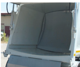
2 Plancher de caisson incliné avec guides latéraux pour l'éjecteur.
